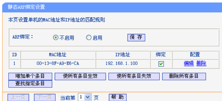
图 5-49 静态 ARP 绑定设置
